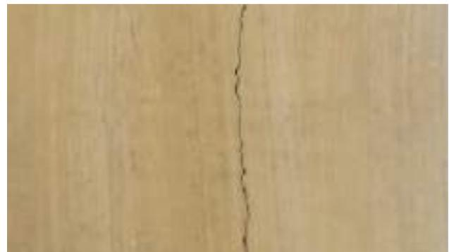
8. Fessurazione di un pannello di terra ABS smagrito con sabbia nel rapporto 1:3 in peso e stabilizzato con 5% di calce. Senza stabilizzazione con calce lo stesso impasto non ha mostrato fessurazioni
